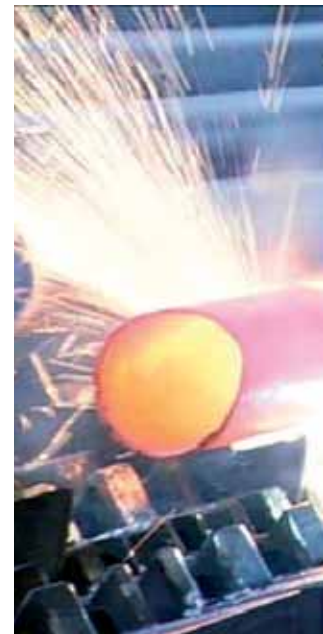
STOSSBANK / Die Dornstange, auf deren vorderem Ende der Hohlblock aufgespresst ist, wird mittels der unter Flur laufenden, 50 m langen Zahnstange durch die nicht angetriebenen Walzgerüste mit abnehmenden Querschnitten gestoßen und so zur "Rohrluppe" ausgewalzt.
