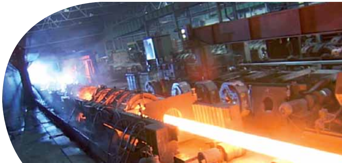
STOSSBANK / Die Dornstange, auf deren vorderem Ende der Hohlblock aufgespresst ist, wird mittels der unter Flur laufenden, 50 m langen Zahnstange durch die nicht angetriebenen Walzgerüste mit abnehmenden Querschnitten gestoßen und so zur "Rohrluppe" ausgewalzt.
